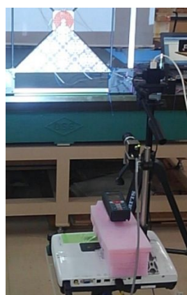
ベストフィット平面からの変位量計測（平織CFRP薄膜下向き負荷）
