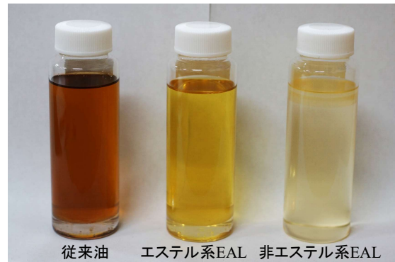
図7 潤滑油の経時変化の一例 (海水混入2週間後)
