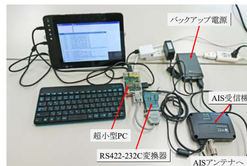
図 1 作成した AIS 受信システム
