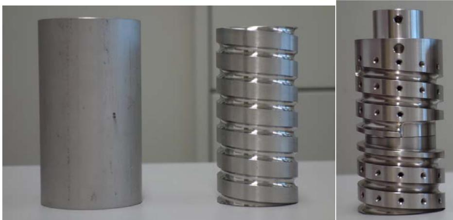
図6 導体巻棒(中央)と熱処理時の外周拘束治具(左)ねじり印加のための試料ホルダー(右)
