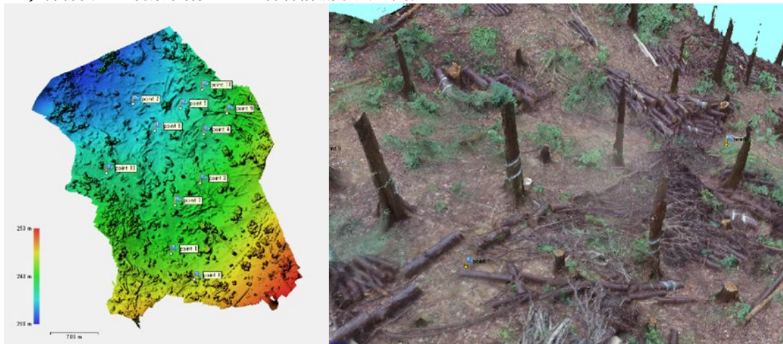
図1. 森林内 UAV 撮影画像から生成された3次元モデル
