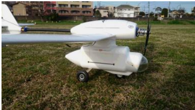
第3図 長時間飛行用情報収集固定翼機
