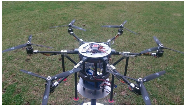
第1図 低重力実験用ドローン（ヘキサコプター）
