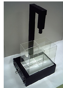
図1. 掻破行動解析装置SCLABA®-Real
