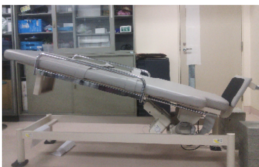
図3：ティルトベッドの写真（-15°のヘッドダウンティルト時）
