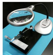
図2 毛髪断片作製装置
