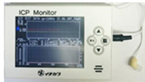
Fig.2 外耳道内圧脈波測定装置
