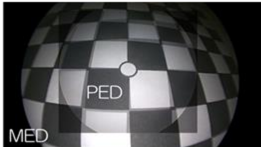
図 8 photoshop で歪みを補正した PED 画像を重畳した MED 画像 視野的には半分程度になっている。
