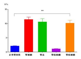
パルスジェットメスの条件を腎実質が切離でき、腎癌の被膜を損傷しない強さに調整
