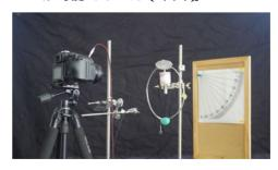
涙液に見立てた振り子の潤滑剤としてヒアルロン酸 (HA)溶液を用いたところ、ヒアルロン酸濃度が 0.2%までは SCL 上の摩擦係
