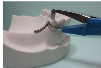
図3 簡易型維持力測定装置の測定状況
