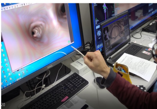
図 6 カテーテルの先端を動かして表示された腔内画像をリアルタイムに操作する様子
