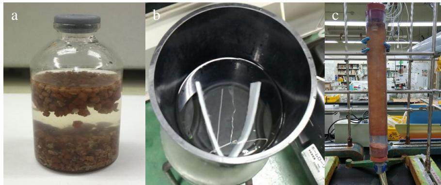
図 2 “*Ca. Scalindua*”の集積培養に用いた上向流カラムリアクター：a) 植種した複合微生物試料、b) 不織布担体、c) 上向流カラムリアクター。
