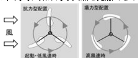
図3 抗力型配置と揚力型配置
