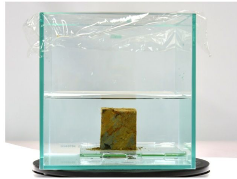
実験水槽に地質試料を浸水した状態(近岡、2017MS)
