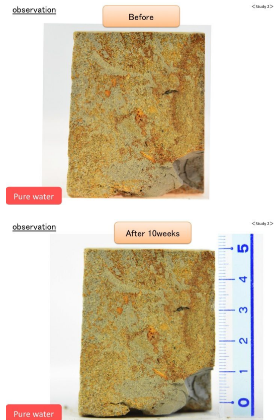
超純水に浸水した場合(上:浸水前、下:10 週後)(近岡、2017MS)
