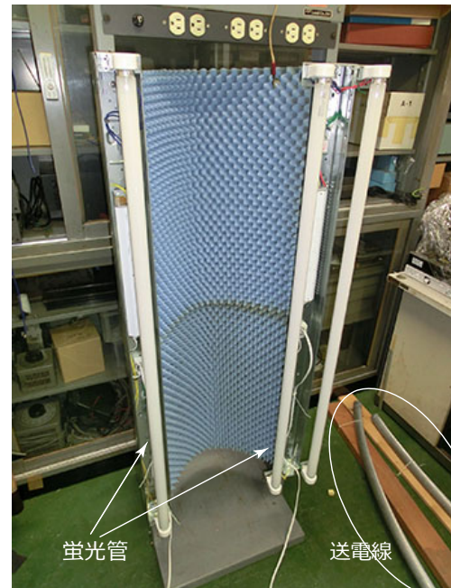
図4 測定対象（蛍光灯）
