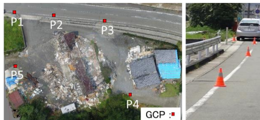
図 5 GCP の配置図と使用した標定点
