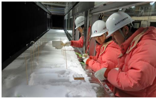
図 4 小型シアーフレームによるせん断破壊試験。雪氷防災研究センターCES.
