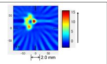
Fig. 1. DPPH の模擬試料による 2 次元 ESR 画像.
