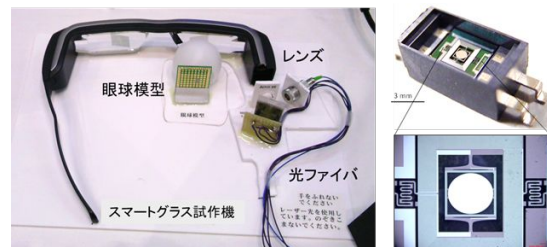
図5 製作したスマートグラス測定装置
