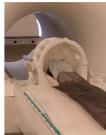
図12. シールドを強化した複数センサーによる温度測定例
