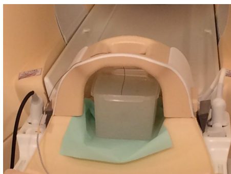
図3. 3テスラ高磁場MR装置のヘッドコイル内に配置した自作インプラントファントム(温度センサー挿入)
