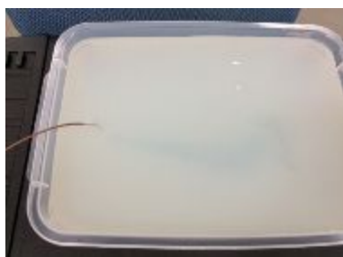
図2. 自作インプラントファントム(温度センサーが挿入してある)
