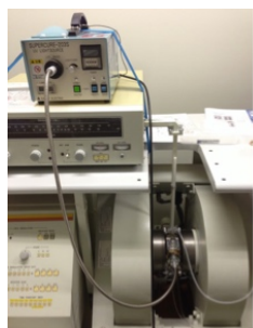
図：MULTIS 法測定に用いるフローインジェクション電子スピン共鳴装置(FI-ESR)
