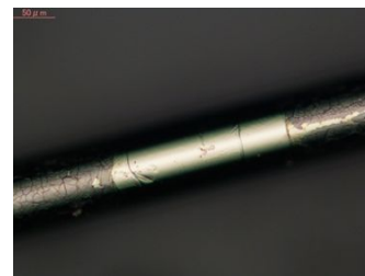
図2 Ni細線を用いた熱CVDの結果
