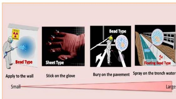
図 12 ビーズ状およびシート状ガラス線量計の応用例
