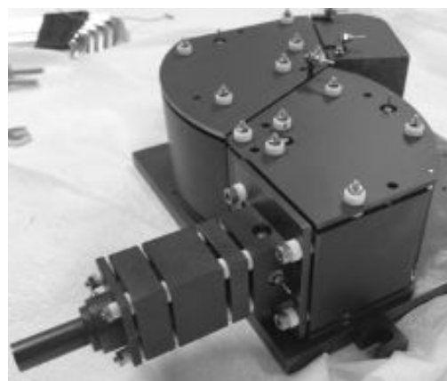
図3 本研究で開発した空間電荷効果を考慮した新型電子モノクロメーター 空間電荷効果を考慮して決定された偏向角を有する、2段の静電円筒型電子エネルギー選別器からなる。
