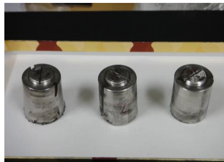
図3 長石の衝撃圧縮実験に用いたセル
