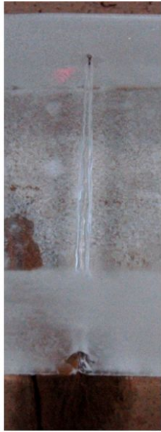
図2 氷に CO 2 レーザーを照射した直後の写真
