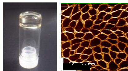
図3 分子 1 がクロロフォルム中で形成するオルガノゲル(左)と基板上で形成したナノファイバーネットワーク構造(右)。
