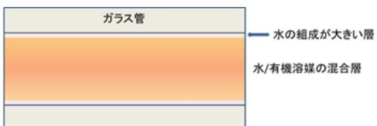
図2 混合溶媒における壁面効果を利用したLLW(タイプ1)の概念図
