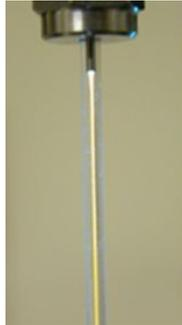
図1 シースフローを利用する液液光導波路(混じり合う溶媒による)
