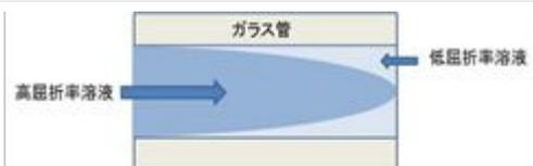
図3 層流中の線速度分布を利用する動的LLW(タイプ2)の概念図
