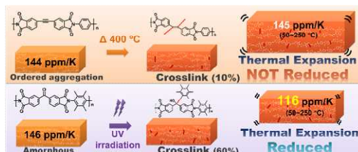
[図 4] 熱・光架橋性 PI の凝集構造と CVE 挙動。
