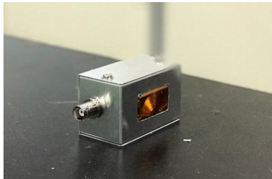
図 2 開発した点集束型電磁超音波センサの一例。中央のオレンジ色の領域がセンサ部。センサ部が試験体と接するように設置して使用する。
