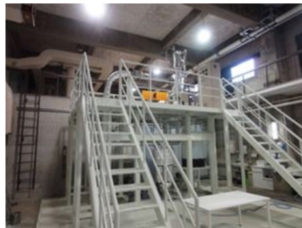
図3 キャビテーション運転中の溶存酸素量のモニタリングを行ったキャビテーションタンネル
