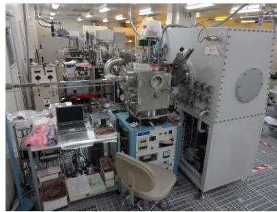
図1 本研究で用いたグローブボックス付設置型有機薄膜蒸着装置。
