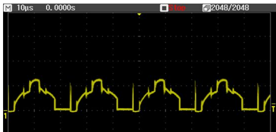
図 3 : SiC MOSFET ドレイン-ソース間電圧
