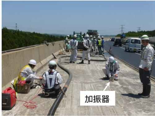
図-2 道路橋の現場試験状況
