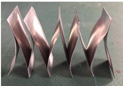
図 6. 蛇腹構造熱電デバイス
