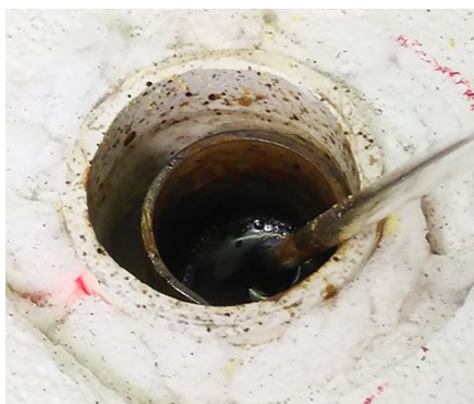
図3 溶融硝酸塩中での PtO 2 -CeO 2 生成
