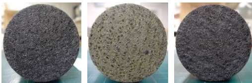
図 1 アーク加熱試験用供試体(左から炭素基材, ポリイミド含浸アブレータ, 炭化材)
