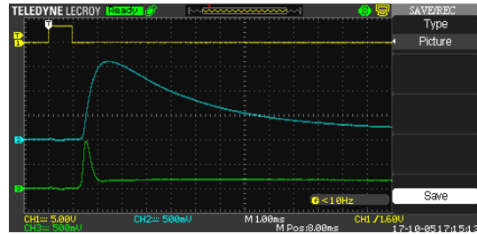
図6 ビーム実験時の電離真空計の圧力変動 緑：ABIE 外、青：ABIE 放電室内
