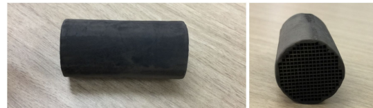
図 2 . N 2 O 分解ハニカム触媒
