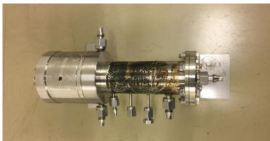
図 1 . N 2 O 小型ガス発生装置（触媒分解）
