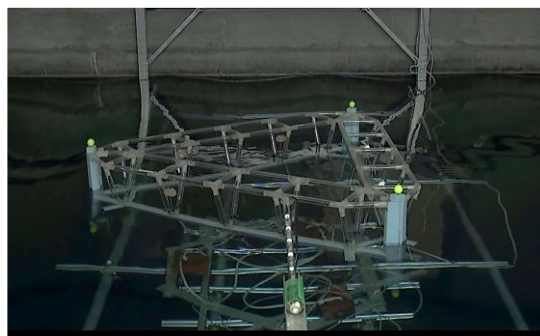
図 5：TLP浮体の水槽実験の様子
