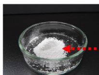
図 6 CO 2 ガスを利用した炭酸リチウム生成法
