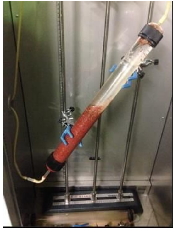
図1 アナモックス集積培養リアクター
