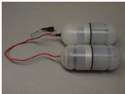
図 5 試作機を内蔵した防水ケース（上に本体が、下に電源ボックスが内蔵されている）
