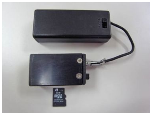
図 3 試作機の全体像（上が電源ボックスで下が本体及び micro SD カード）
