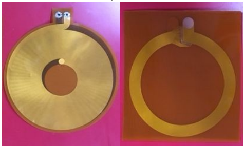
図 1 作製したフレキシブル基板 (左) 並列向けモデル (右) 直列向けモデル
