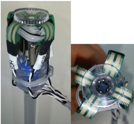
図1：力センサー付き内視鏡手術用ポート 左写真は横から、右写真は上から見た外観。 鉗子を挿入した際に鉗子がポート内にかかる圧を検知できるように圧センサーを設置している
