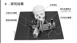
位置決め機構として並進と回転を併せ持つ新しいパラレルメカニズムを考案し、評価実験を通して位置決め 3DOF (degrees of freedom)のうちY並進及びZ並進で位置決め精度0.1mm以下を有することが確かめられた。
